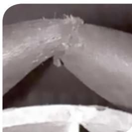
**FALHA** Deformação no furo de encaixa da mola pneumática.
