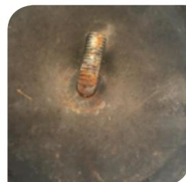
**FALHA** Rompimentos próximos da base.
